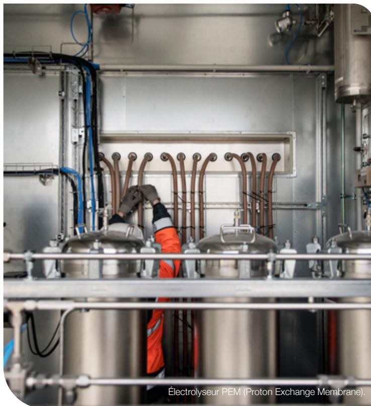
Électrolyseur PEM (Proton Exchange Membrane).
